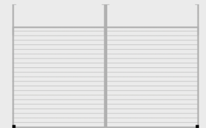
Pérgolas con vigas desplazadas
